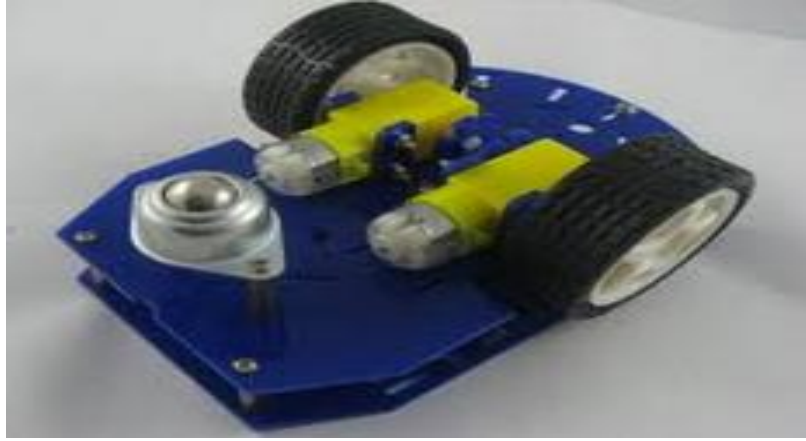
الشكل 3. يبين قيادة تفاضلية بعجلتين مع نقطة اتصال ثالثة
